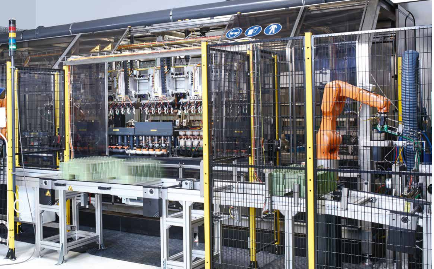
Anlage zur Einzelteilbeschichtung von Ventilen für die Automobilindustrie im Fast Plating Center der Holzapfel Group
